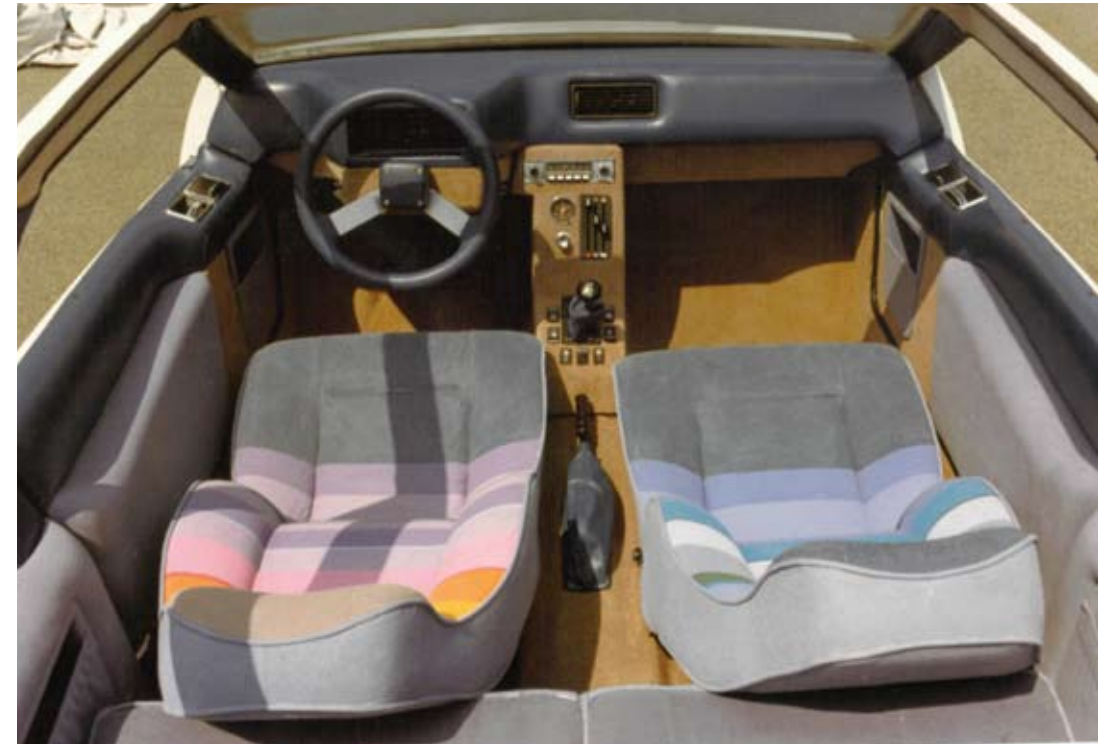
Sièges arrière indépendants, coulissants, sièges avant charmarés, confortables... L'intérieur du projet de coupé Renault 14 réutilise toutes les études de Renault sur les véhicules VBG et notamment ces sièges colorés qui seront copiés, plus tard par... la Simca Horizon !
